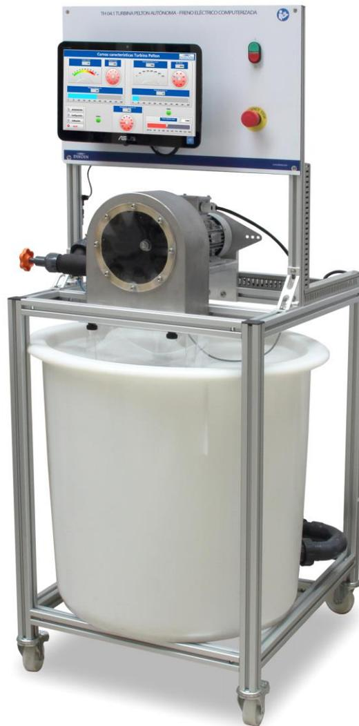
El modelo TH 04.1 representa un avanzado simulador de turbina de Pelton (o turbina de acción) a escala reducida, diseñado específicamente para facilitar el estudio detallado y la visualización en tiempo real del comportamiento y las propiedades dinámicas de dichas turbinas.
