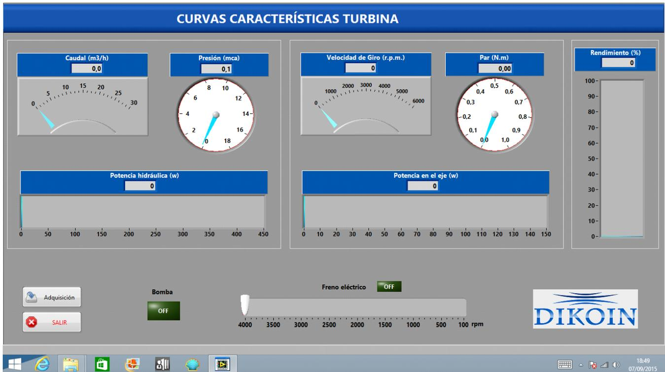
El equipo incluye un PC con el software de manejo del equipo. En el mismo se muestran los parámetros de todos los puntos de control del equipo, y se permite la recogida de datos en modo automático o manual.
