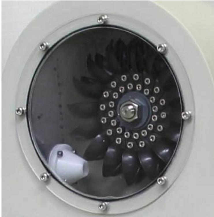
La carcasa transparente de la turbina permite una visualización inmejorable de su funcionamiento.
